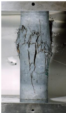
شکل (۴-۱) آزمون استاندارد تعیین مقاومت فشاری استوانه‌ای بتن
